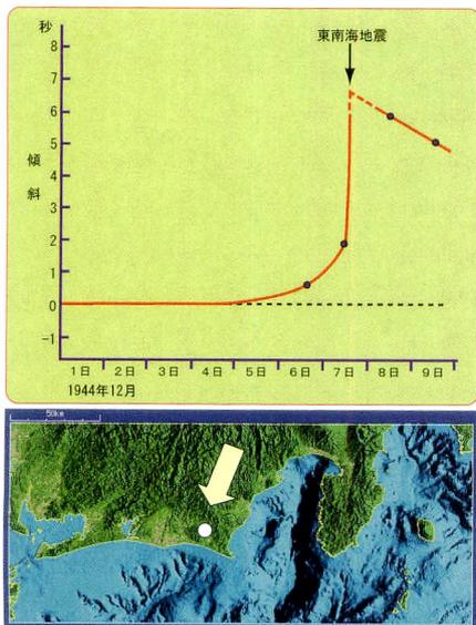
図5-5 1944年の東南海地震(M7.9)直前の掛川付近の傾斜変化
