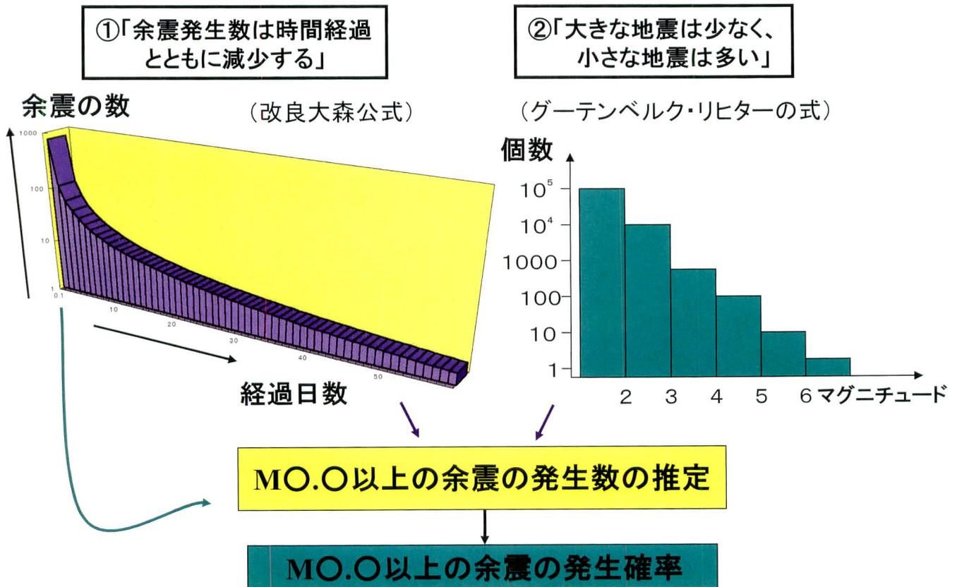
図3-4 余震の発生確率の求め方
