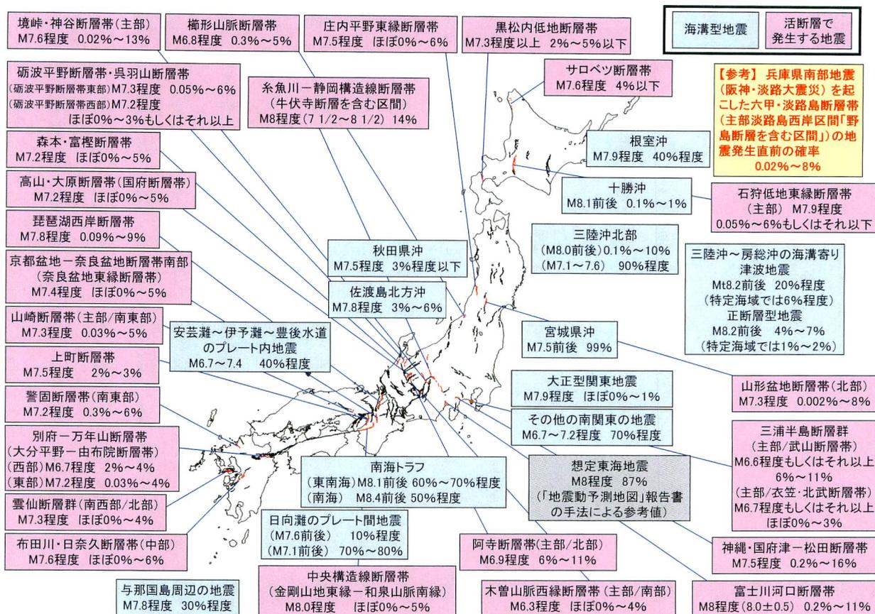
図5-9 主な海溝型地震及び活断層で発生する地震の長期評価結果【地震調査研究推進本部による】
